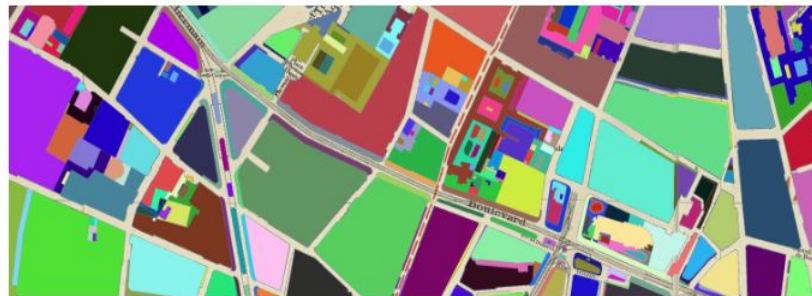
Vectorisation automatique : extraction de géométries structurées dans les planches des atlas municipaux
